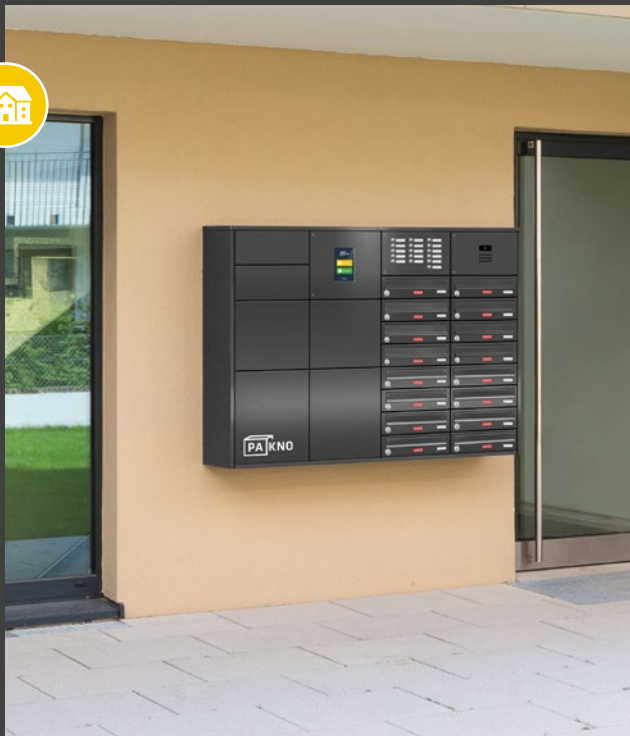
Unterputz-Anlage als Teilwandinbau als Kombination aus Briefkasten- und Paketanlage PAKNO mit elektronischer Schließlösung PAKNO, mit 16 Briefkästen, zwei Funktionskästen für Klingeln und Videomodul und sechs Paketkästen, Einwurf und Entnahme vorn, Verkleidung RI232, pulverbeschichtet in RAL 7016 Anthrazitgrau
