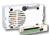
Audiolautsprecher 1621 und Montagezubehör 1250U Lautsprechereinheit für 2-Draht-Anlage mit Klemmenleiste und Sprechverbindung mit Echounterdrückung, staub- und wasserdichtem Lautsprecher, Elektret-Mikrofon und an der Frontseite einstellbarer Lautstärke des Lautsprechers; Mikroprozessor und DIP-Schalter mit 8 Positionen für die Programmierung der Teilnehmeradressen; integrierte elektronische Türöffnerfunktion (3 A) und zusätzliche Relaiskontakte C, NC, NO mit 10 A; zeitgeschalteter Türöffnereingang und Anzeige „Tür offen“. Maße: 102 x 55 x 38 mm (BHT)
