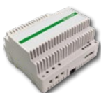
2-Draht-Netzteil 1210A Netzgerät mit Ringkerntrafo, Überlast- und Kurzschluss-sicherung für das 2-Draht-System (SB2) zur Versorgung der Außensprechstelle (L1-L1) und der Steigleitung (L2-L2). Ausstattung mit einer Klemme für den Leitungsabschluss Art. 1216. Eingangsspannung 110-240V AC. Abmessungen: 8 DIN-Module.
