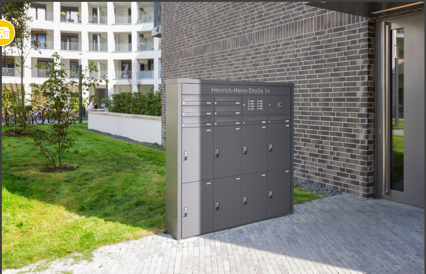
Freistehende Anlage als Kombination aus Briefkasten- und Paketanlage mit mechanischer Schließlösung CLEVERLOCK, mit acht Brief- und acht Paketkästen (jeder Bewohner hat seinen eigenen Paketkasten), zwei Funktionskästen für Klingeln und Videomodul, Einwurf und Entnahme vorn, Verkleidung RI252, pulverbeschichtet in RAL 9007 Graualuminium
