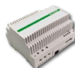
2-Draht-Netzteil 1210A Netzgerät mit Ringkerntrafo, Überlast- und Kurzschluss-sicherung für das 2-Draht-System (SB2) zur Versorgung der Außensprechstelle (L1-L1) und der Steigleitung (L2-L2). Ausstattung mit einer Klemme für den Leitungsabschluss Art. 1216. Eingangsspannung 110-240V AC. Abmessungen: 8 DIN-Module.
