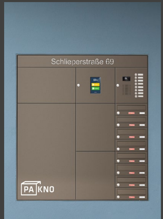
Unterputz-Anlage als Kombination aus Briefkästen- und Paketanlage PAKNO mit elektronischer Schließlösung PAKNO, mit acht Briefkästen, einem Funktionskasten für Klingeln und Videomodul und fünf Paketkästen, Einwurf und Entnahme vorn, Schattenfugenrahmen TE150, pulverbeschichtet in RAL 8028 Terrabraun
