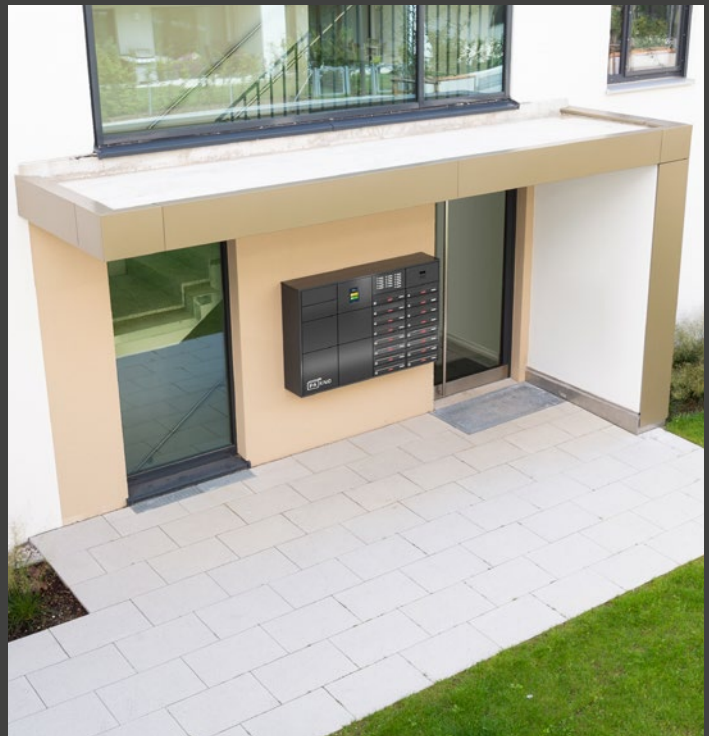
Unterputz-Anlage als Teilwandinbau als Kombination aus Briefkasten- und Paketanlage PAKNO mit elektronischer Schließlösung PAKNO, mit 16 Briefkästen, zwei Funktionskästen für Klingeln und Videomodul und sechs Paketkästen, Einwurf und Entnahme vorn, Verkleidung RI232, pulverbeschichtet in RAL 7016 Anthrazitgrau
