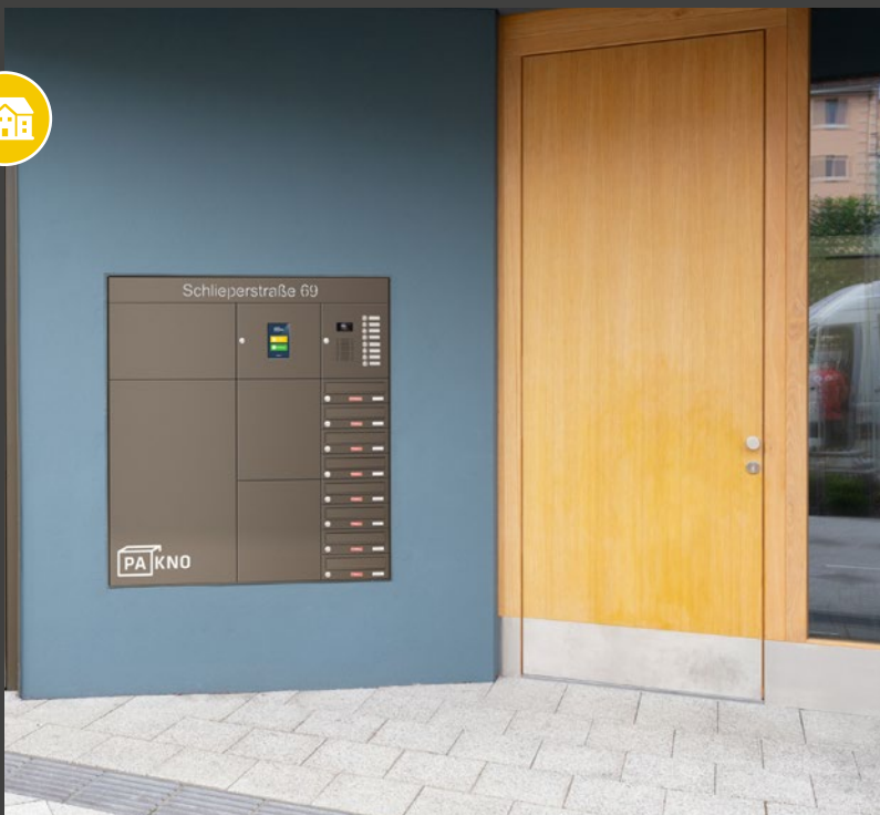
Unterputz-Anlage als Kombination aus Briefkästen- und Paketanlage PAKNO mit elektronischer Schließlösung PAKNO, mit acht Briefkästen, einem Funktionskasten für Klingeln und Videomodul und fünf Paketkästen, Einwurf und Entnahme vorn, Schattenfugenrahmen TE150, pulverbeschichtet in RAL 8028 Terrabraun
